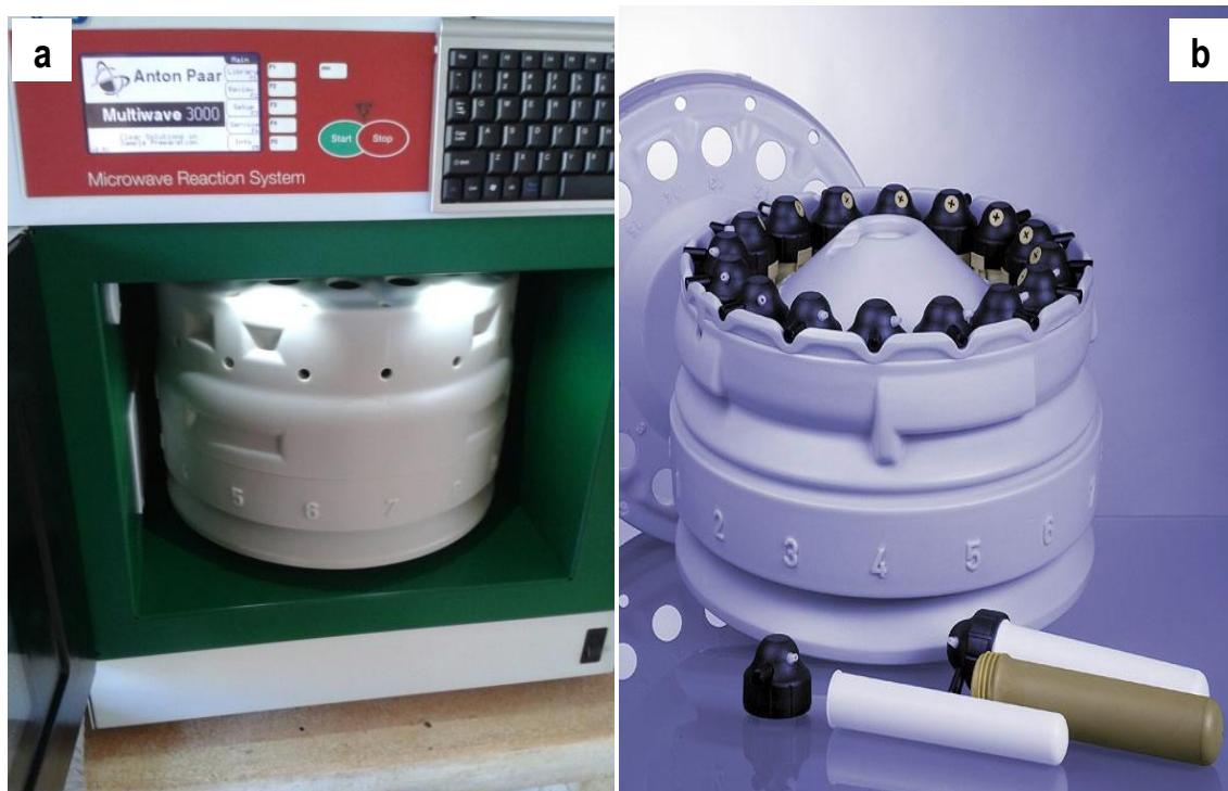
FIGURA 5. Forno de micro-ondas modelo Multiwave 3000, da Anton Paar (a), rotor e tubos de teflon (b) usados na digestão das amostras de solo.
