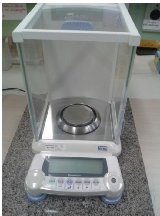
FIGURA 3. Balança analítica de alta precisão, utilizada para pesagem de amostras de solos.
