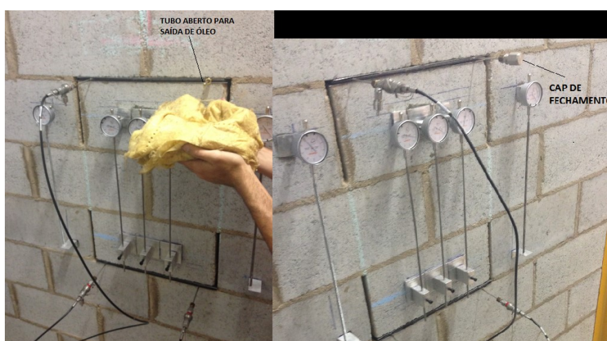
Figura 109: Processo de preenchimento do sistema com óleo.
