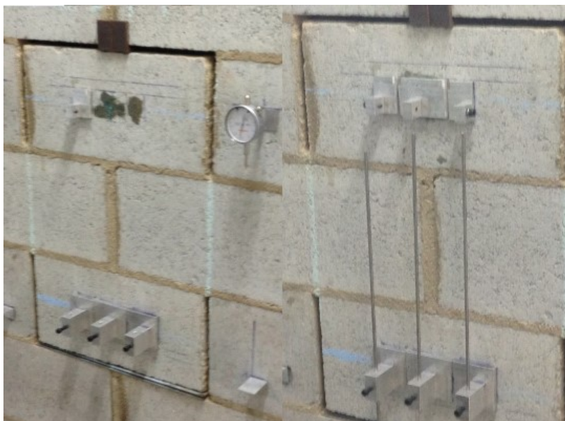
Figura 107: Colagem e montagem do sistema de leitura de deformação.
