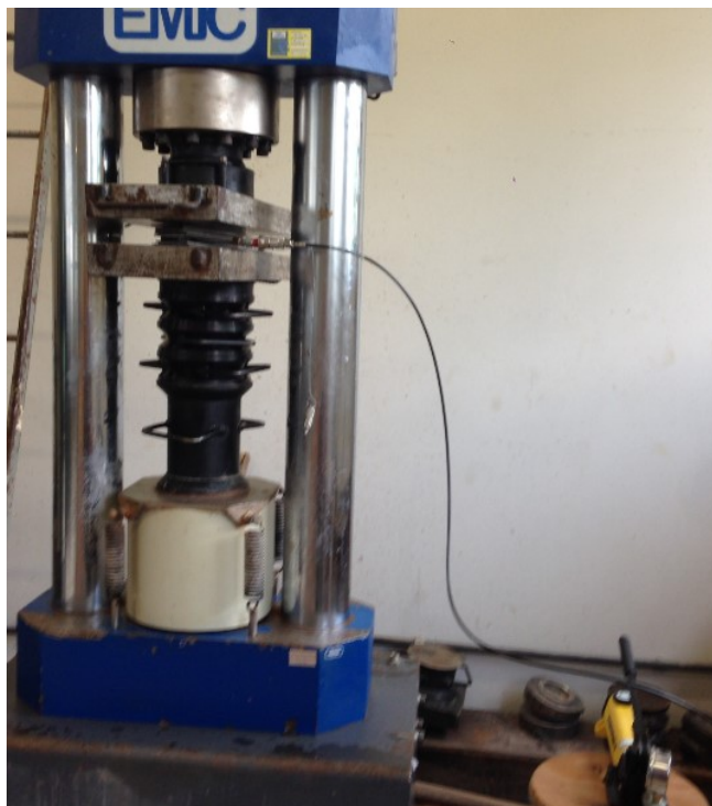
Figura 76: Bomba conectada ao macaco confinado na prensa hidráulica durante o teste de calibração.
