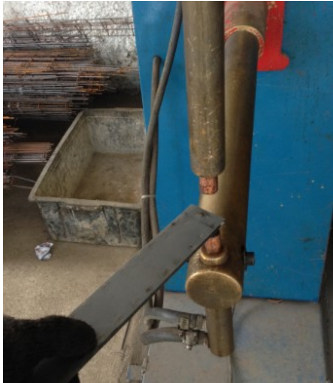
Figura 69: Solda ponto realizada em toda a borda do equipamento.
