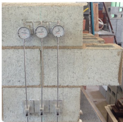
Figura 87: Amostra da parede testada na prensa com sistema de medição de deformação.
