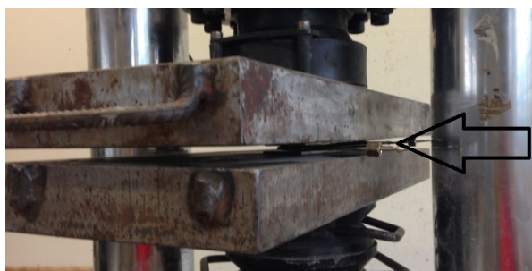
Figura 60: Teste de resistência do macaco 1 na prensa hidráulica.
