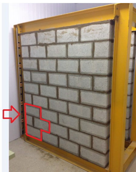
Figura 88: Região removida da parede para teste na prensa.
