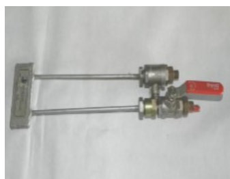
Figura 33: Macaco plano especial desenvolvido para estruturas de concreto.
