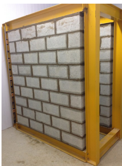
Figura 83: Pórtico metálico e amostra da alvenaria construída.
