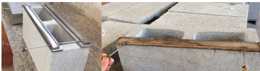
Figura 64: Dois modelos estudados de macacos do protótipo 2 sobre os blocos.
