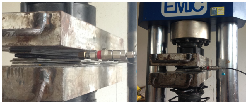
Figura 75: Teste de calibração na prensa hidráulica.
