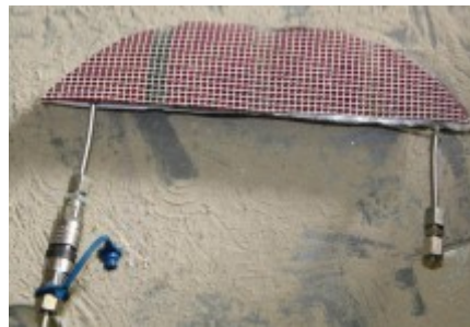
Figura 48: Macaco semioval com rede de marcação.
