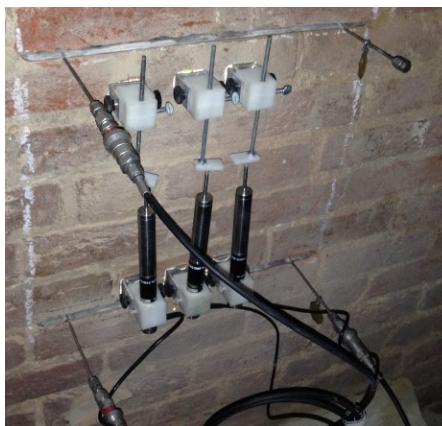
Figura 53: Teste de deformabilidade com LVDTs para obtenção da deformação.
