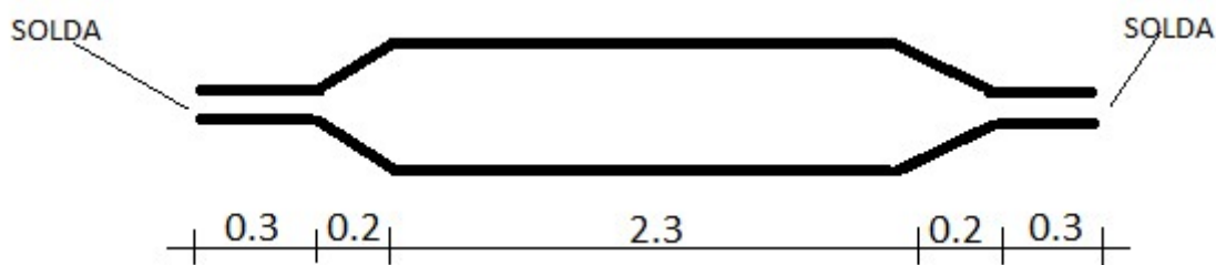
Figura 61: Corte transversal do macaco modelo 2 com medidas em centímetros.
