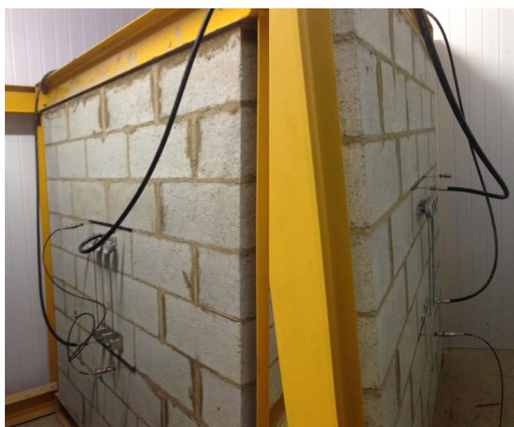
Figura 123: Conexões entre os 4 macacos na parede 4.
