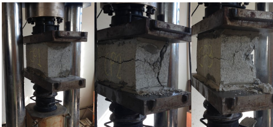
Figura 84: Teste de resistência à compressão nos blocos de concreto.
