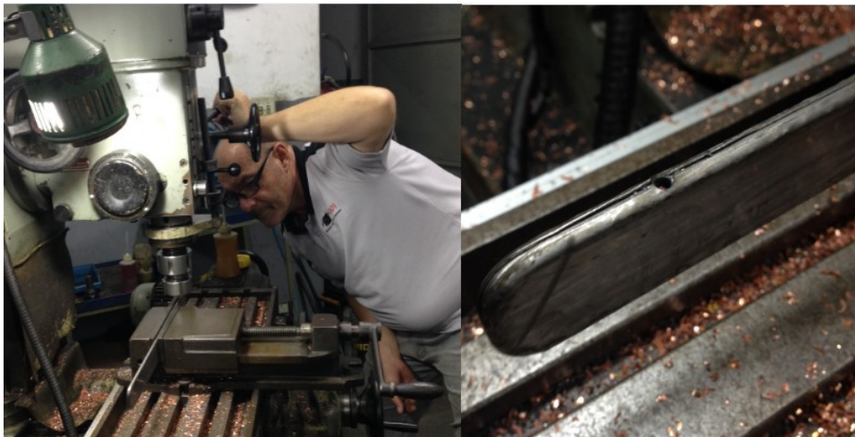
Figura 73: Realização do furo em fresadora.
