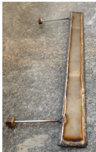
Figura 63: Macaco de uma aba do protótipo 2.
