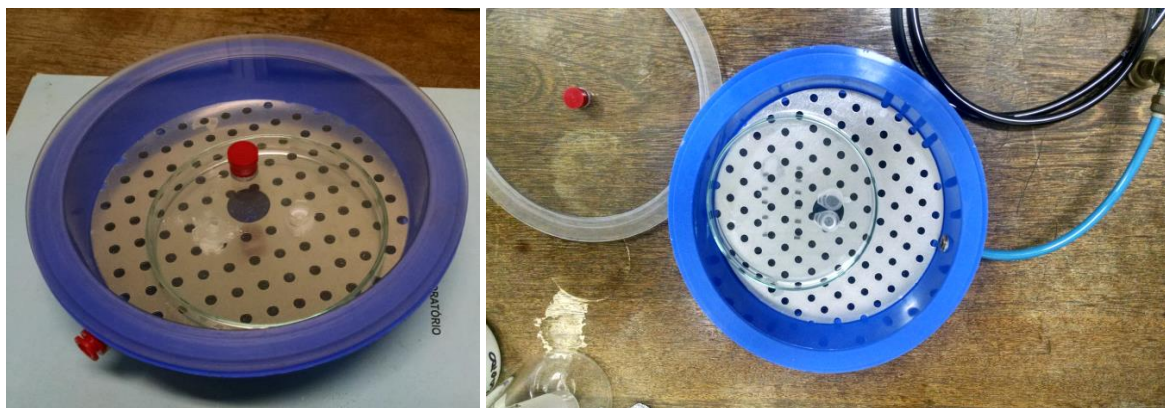
Figura 21 – Dessecador adaptado para vaporização do APTES e ativação da superfície dos microcantilever.
