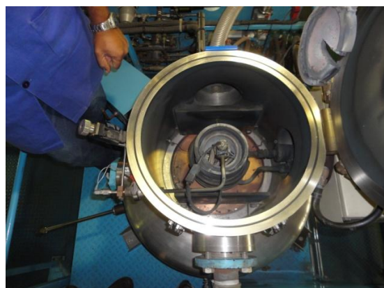
Figura 3.3.1.2 Compartimento para acomodação e fusão dos lingotes
