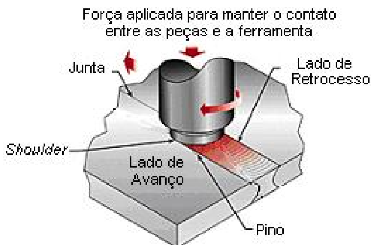
Figura 2.2 – Esquema ilustrativo do processo FSW [19].
