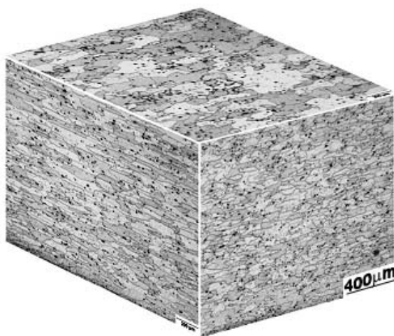
Figura 4.1 – Microestrutura da liga 6056-T4.
