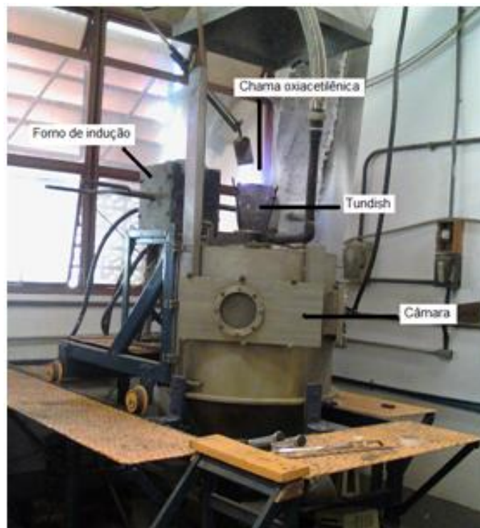
Figura 17 Equipamento de conformação por spray do Laboratório de Fundição do DEMa-UFSCar.
