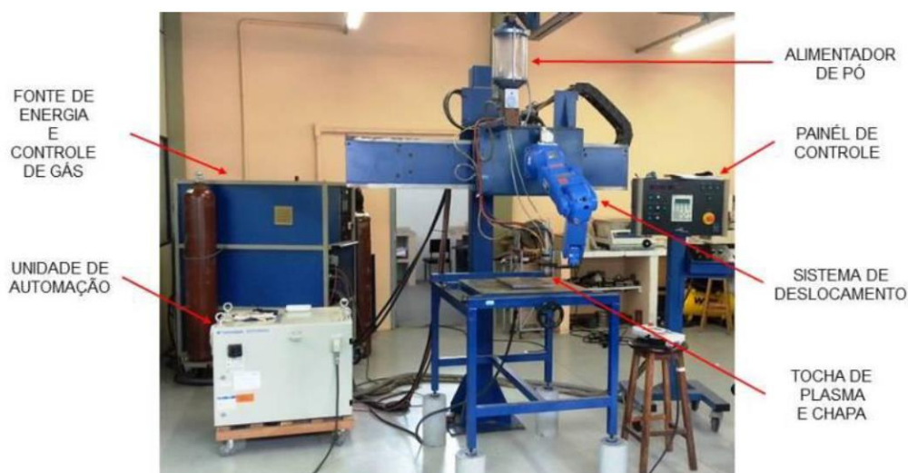
Figura 18 Equipamento de PTA utilizado para o processo de deposição [37].
