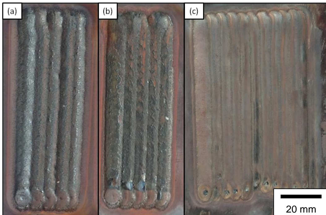
Figura 25 Detalhe do aspecto dos cordões depositados: (a) SMSS + 0,3%B, (b) SMSS + 1,0%B e (c) SDM + 3,5%B.
