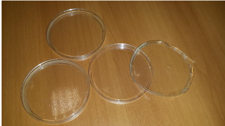
FIGURA 3.8 – Filme livre, à direita, produzido dentro de placa de petri.
