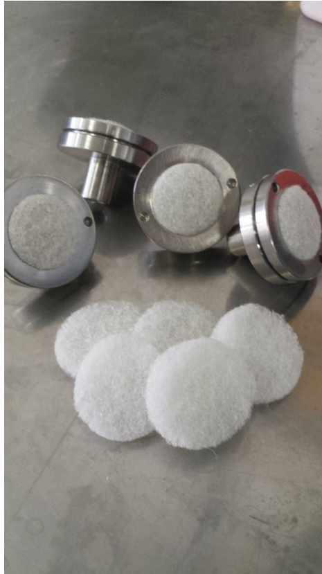
FIGURA 3.4 – Mantas abrasivas utilizadas para simulação de tráfego e desgaste acelerado.
