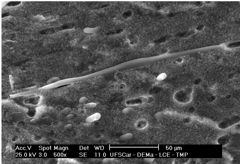
Figura 5.20 - Micrografia de MEV da blenda 10% A, onde pode-se notar a morfologia cilíndrica das partículas de borracha.
