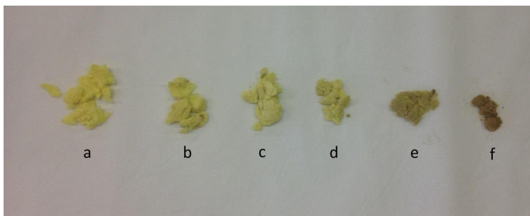
Figura 24 - Comparação visual entre as fibras. a) fibra sem tratamento. b) 2NaOH_30. c) 2NaOH_60. d) 6NaOH_45. e) 10NaOH_30. f) 10NaOH_60.
