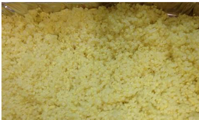
Figura 17 - Mistura obtida após um minuto no misturador Henschel. Fibra de aramida e grânulos de poliamida 6,6.
