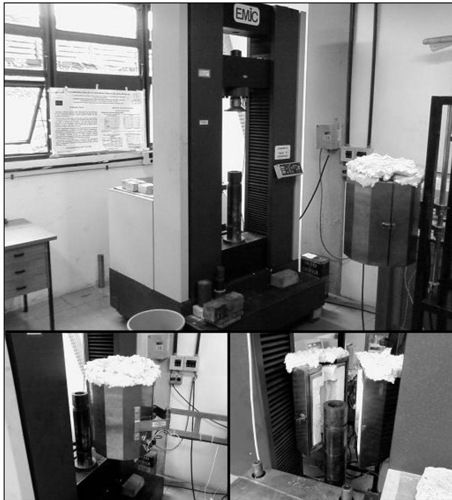
Figura 5.4 - Equipamento de Conformação por Extrusão a quente.
