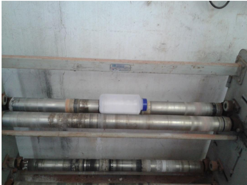
FIGURA 4.1- Moinho de bolas do Laboratório de Cerâmicas DEMA-UFSCar (Fonte: Acervo Pessoal)
