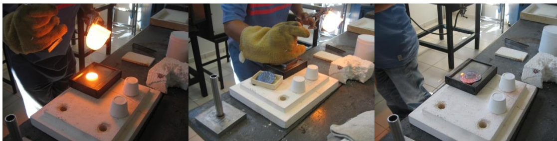
Figura 3.2 Obtenção do vidro mediante Splat Cooling .
