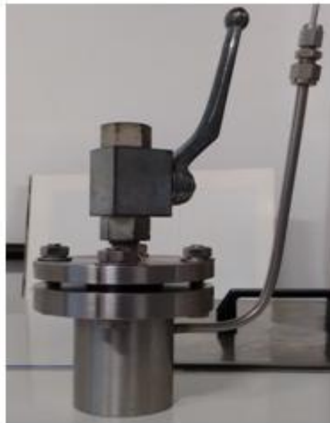
Figura 3.6 Vaso de pressão utilizado no processo de espumação das amostras.
