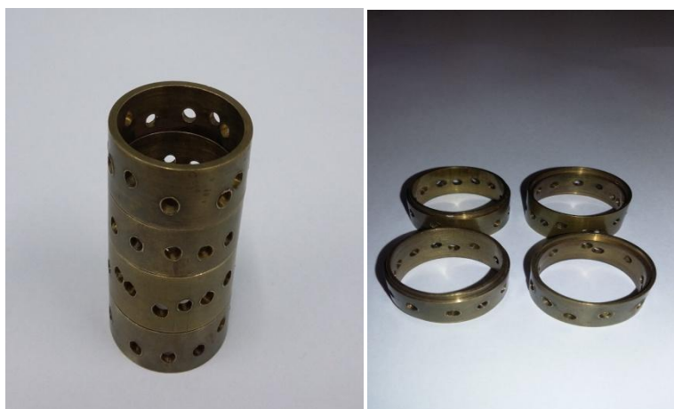
Figura 3.7 Porta-amostra utilizado durante o processo de espumação das amostras no formato de filmes planos.
