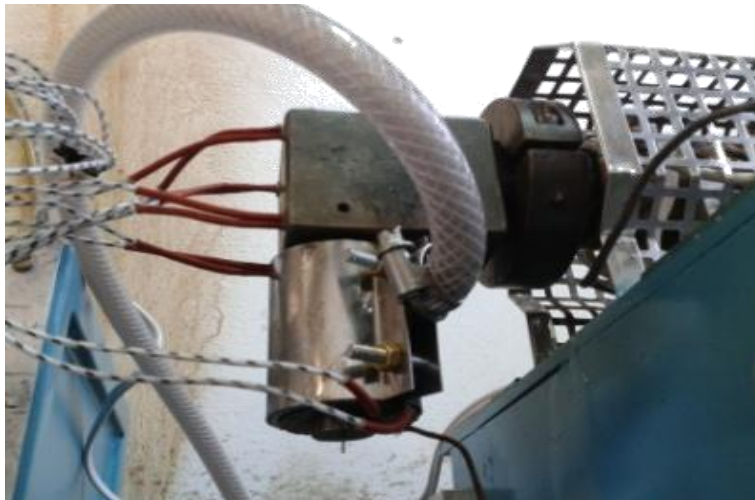
Figura 3.3 Matriz utilizada para extrusão das amostras no formato de fibras ocas.
