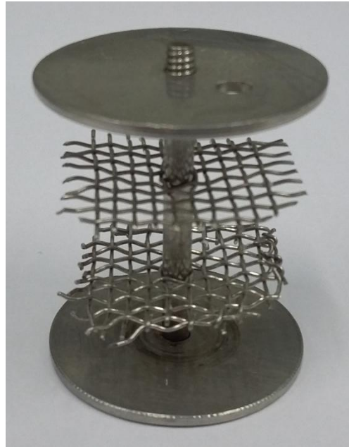
Figura 3.5 Porta-amostra utilizado durante o processo de espumação das amostras no formato de fibras ocas.
