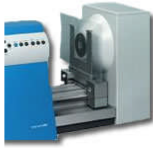
Figura 3.3 - Equipamento para medição de transparência
