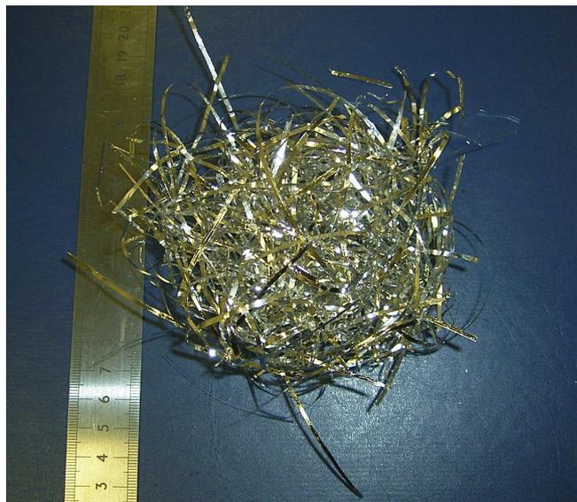
Figura 3.5: exemplo de amostra da liga  $\text{Al}_{89}\text{Y}_{10}\text{Fe}_1$  obtida pela técnica de *melt-spinning*.
