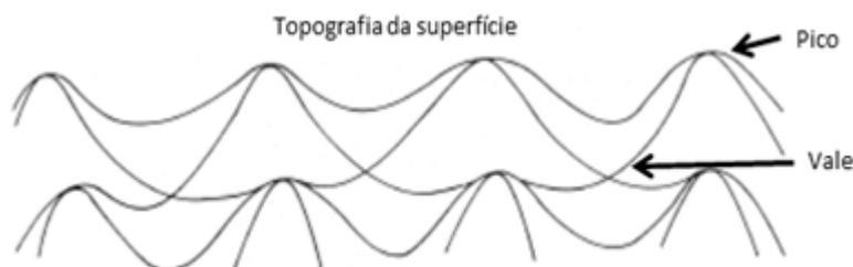
Figura 2.1 Representação esquemática das irregularidades superficiais ressaltando as regiões dos picos e dos vales [adaptado de 9].
