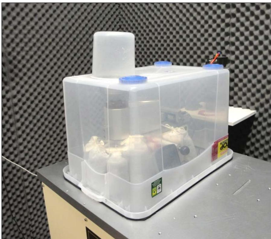
Figura 3.9 Tribômetro com sistema de controle de umidade.
