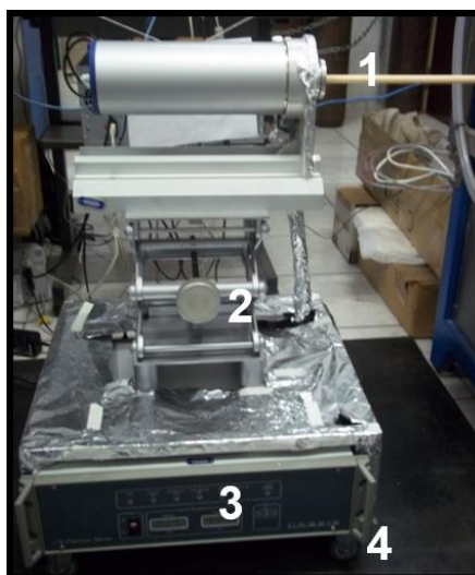
Figura 3.2 – Elementos que conformam o suporte do dilatômetro. (1) dilatômetro; (2) elevador mecânico; (3) gaveta do controlador e (4) rodas.
