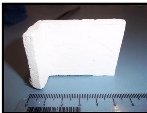
Figura 3.5 – Susceptor desenvolvido com geometria especial para o aquecimento do dilatômetro.
