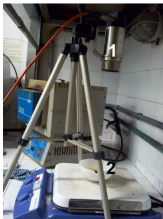
Figura 4.3 – Medição da temperatura durante as reações pirolíticas de decomposição do gel precursor. (1) pirômetro (2) amostra.
