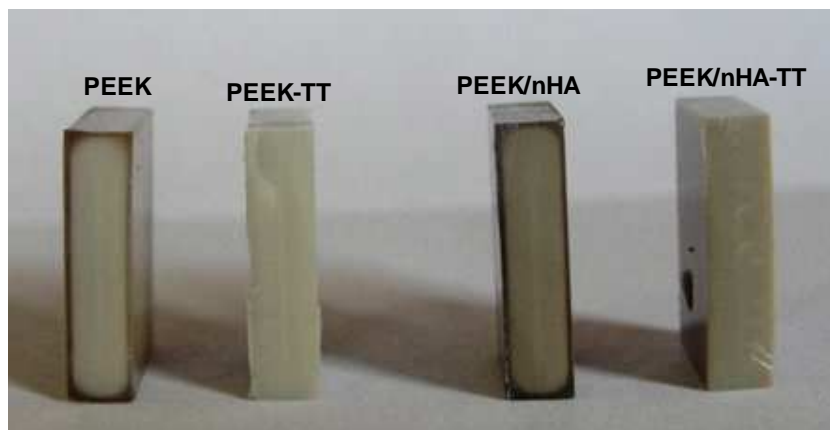
Figura 4.21 Corte transversal dos corpos de prova injetados antes e após tratamento térmico.
