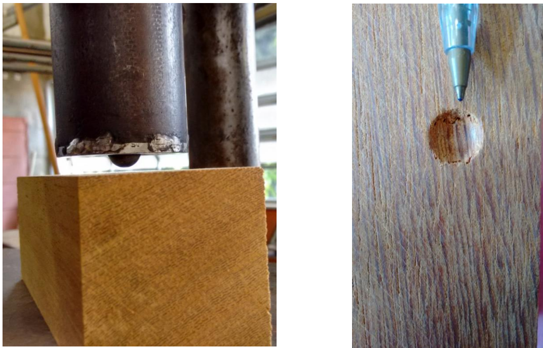
Figura 3.33 - Dureza Janka da madeira de Cupiúba na direção normal às fibras.
