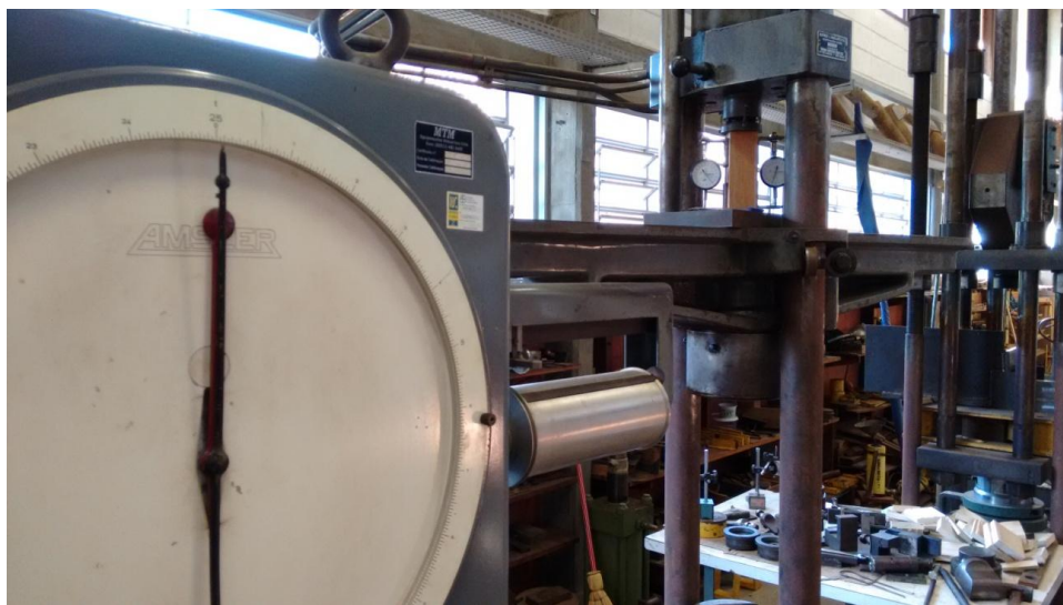
Figura 3.7 - Vista geral da máquina de ensaio para a compressão paralela às fibras.
