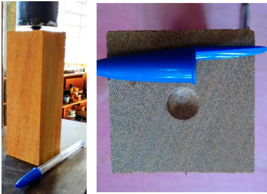
Figura 3.32 - Dureza Janka da madeira de Cupiúba na direção paralela às fibras.
