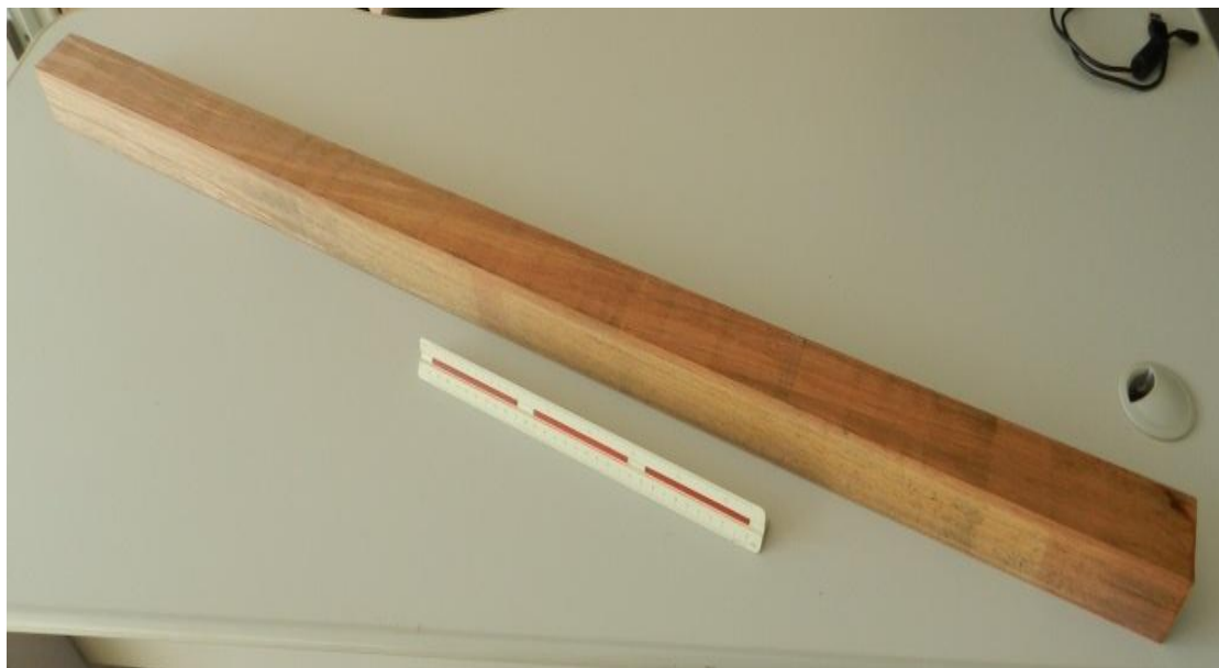
Figura 3.25 – Corpo de prova de madeira de Cupiúba para o ensaio de flexão estática.
