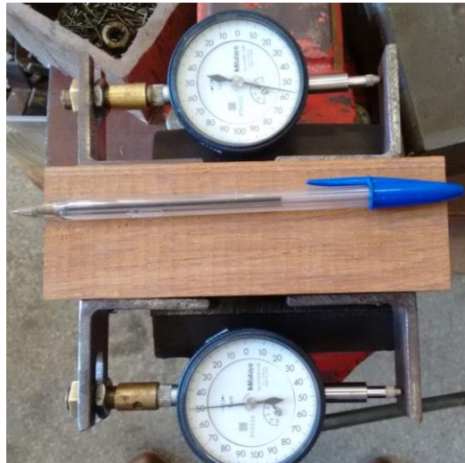
Figura 3.5 - Padrão de fixação dos relógios comparadores no corpo de prova.
