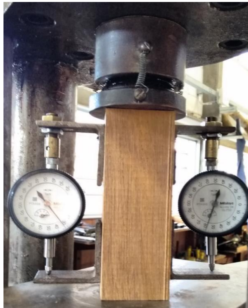
Figura 3.6 - Posicionamento do corpo de prova e dos relógios comparadores na máquina de ensaio para o ensaio de compressão paralela às fibras.
