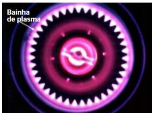
Figura 2.1. Formação da descarga brilhante (bainha de plasma) [11].
