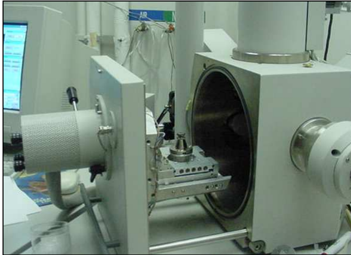
Figura 3.8. Câmara para amostra de um microscópio eletrônico de varredura.
