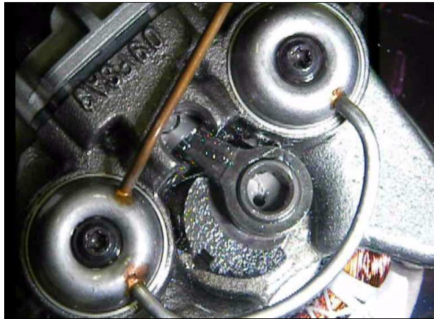
Figura 1.1. Detalhe da biela (ao centro) utilizada em um compressor hermético de refrigeração.
