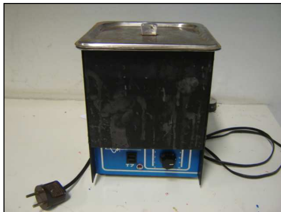
Figura 3.2. Dispositivo de ultra-som para limpeza das amostras.
