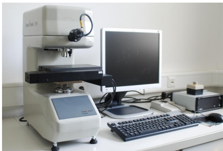
Figura 3.5 – Equipamento Zwick/Roell ZHV utilizado no levantamento dos perfis de microdureza Vickers.
