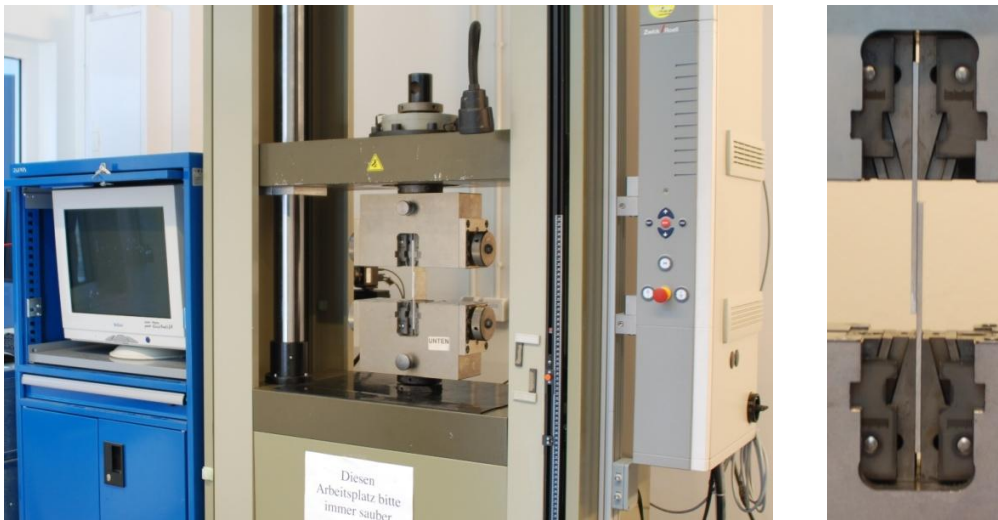
Figura 3.4 – Máquina Zwick/Roell para o ensaio de cisalhamento por tração e detalhe do sistema de fixação.
