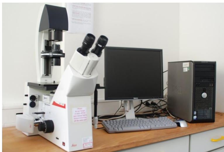
Figura 3.8 – Microscópio ótico Leica DM IRM para análise metalográfica.
