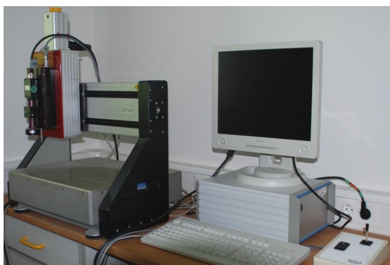
Figura 3.6 – Equipamento ultrassônico BAQ UT100 utilizado no mapeamento da microdureza Vickers.
