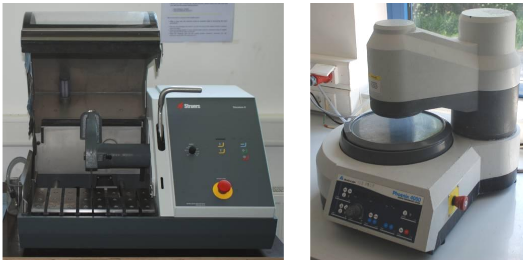
Figura 3.7 – Cortadeira Struers Discotom-6 e lixadeira e politriz universal Buehler Phoenix 4000.
