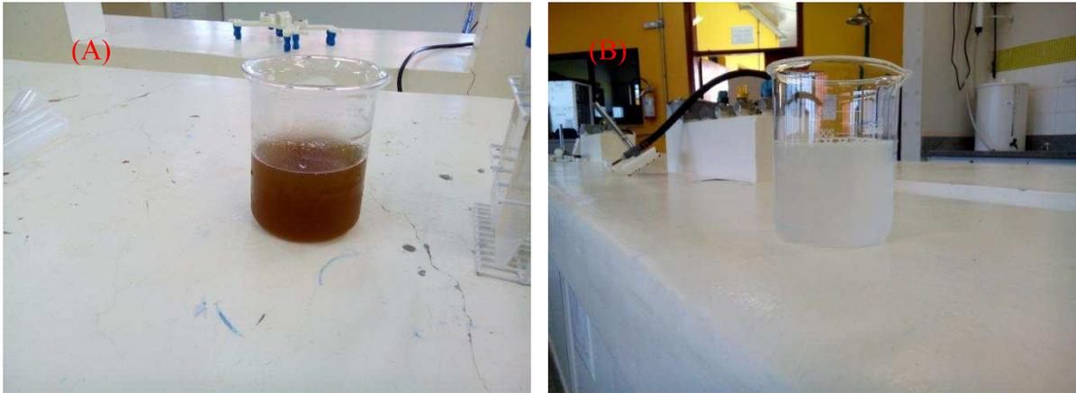
Após a realização da hidrólise e centrifugação de todas as amostras pode-se observar que houve uma variação na turbidez das suspensões contendo a nanocelulose. Isso pode ser um indicativo de diferença no rendimento de cada amostra, o que caracteriza que há diferença na efetividade para cada condição e parâmetros de hidrólise.
