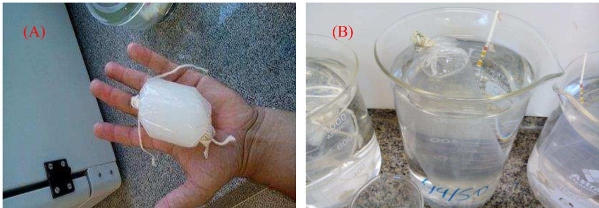
Após as amostras atingirem pH em torno 6,4 as suspensões foram coleadas e a massa de uma quantidade de cada amostra foi medida e adicionada à um recipiente para que o rendimento fosse calculado através da diferença de massas iniciais e massas finais após o período em estufa.
