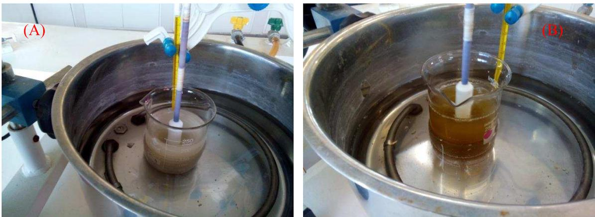
Após o período de 1 hora o béquer contendo a solução e as fibras foi colocado em banho de gelo para que o processo de hidrólise fosse interrompido. Em seguida o material foi centrifugado e o sobrenadante contendo as fibras que não foram hidrolisadas foi descartado.
