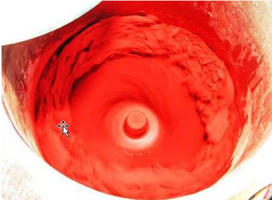
Figura 3.4 Processo de obtenção de composto dry blend
