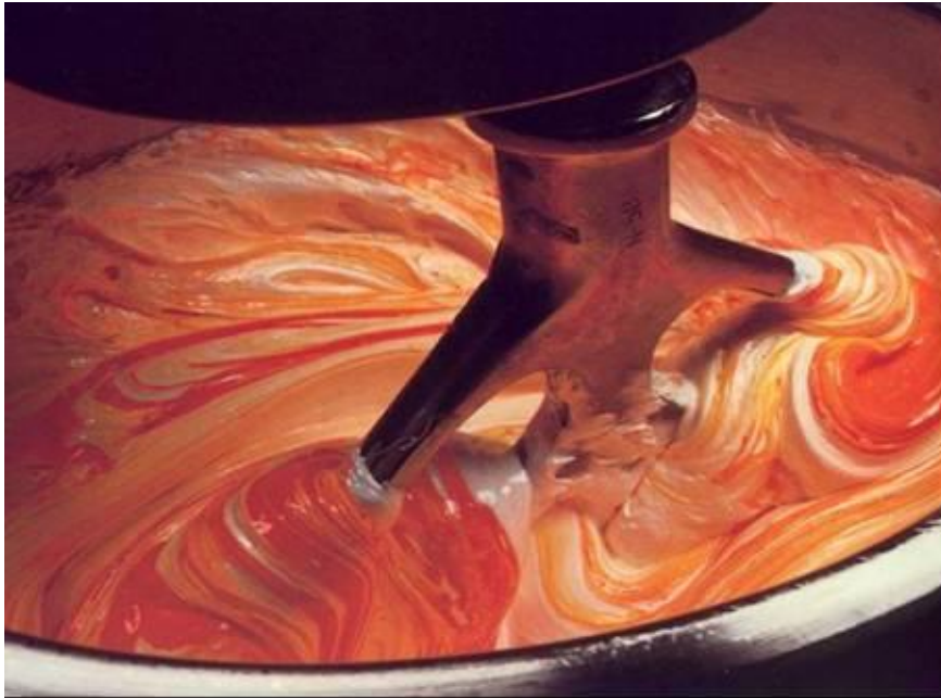
Figura 3.7: Processo de obtenção de composto plastisol
