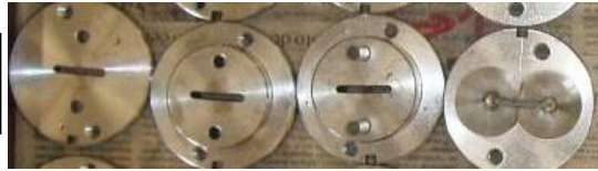
Figura 3.11 Foto dos conjuntos de matrizes de extrusão tipo placas paralelas (ou retangulares) e suas respectivas matrizes intermediárias, construídas para o cabeçote da ERDCI da Werner Pfleiderer.[1]
