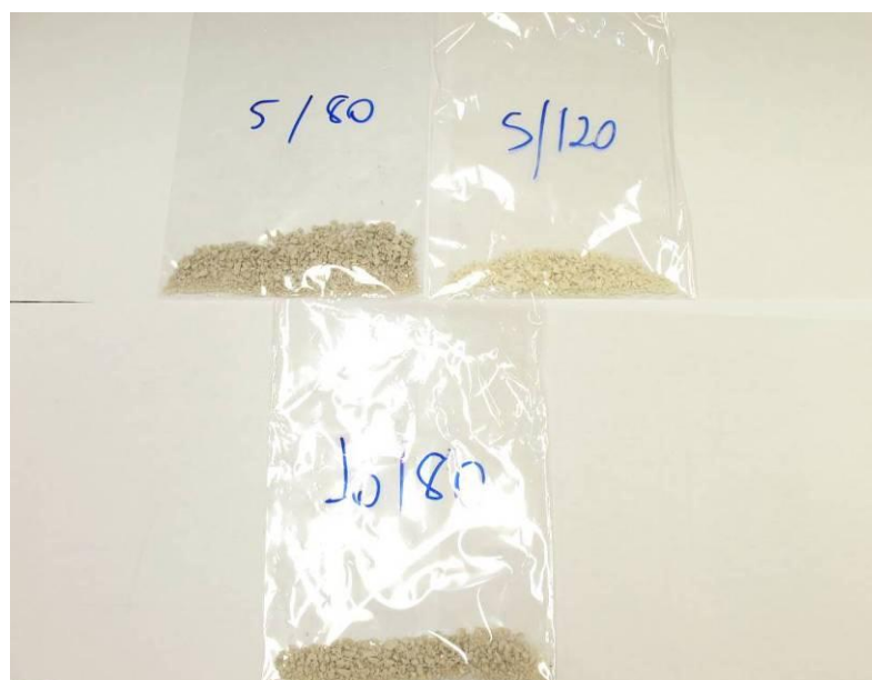
Figura 4.35 Fotografias das amostras de PBT processadas em misturador interno Haake à 275°C com diferentes tempos de processamento e velocidades de rotação dos rotores moídas em moinho de facas.
