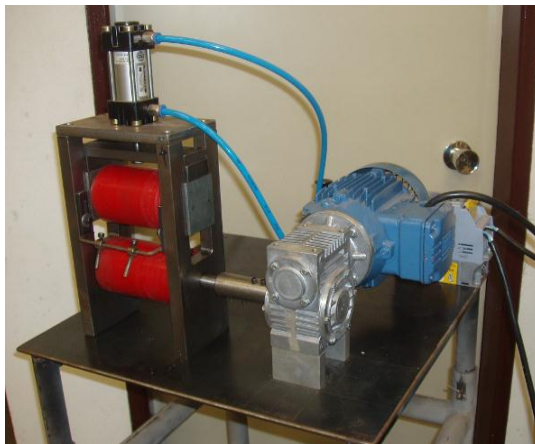
Figura 3.3 Fotografia do puxador de perfis com moto variador de velocidade de 0,5 até 50 m/mim [1].
