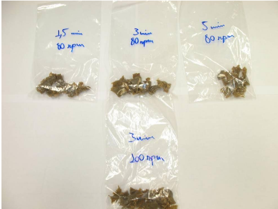
Figura 4.32 Fotografia das amostras de ABS processadas em misturador interno Haake à 275°C com diferentes tempos de processamento e velocidades de rotação dos rotores
