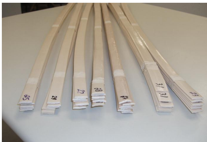
Figura 3.5 Fotografia de perfis extrudados (fitas) das blendas PBT/ABS para estudo morfológico e propriedades mecânicas.
