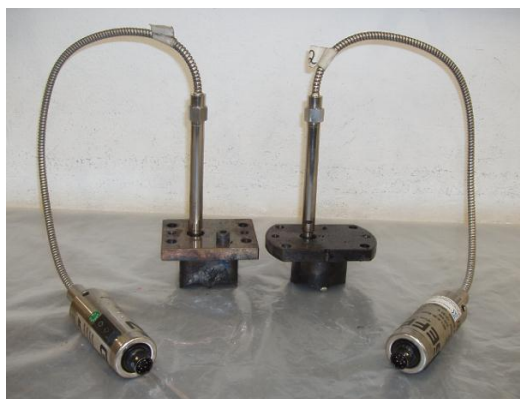
Figura 3.2 Fotografia dos dois dispositivos para acoplamento dos transdutores de pressão para a ERDCI Werner-Pfleiderer modelo ZSK30 [1].
