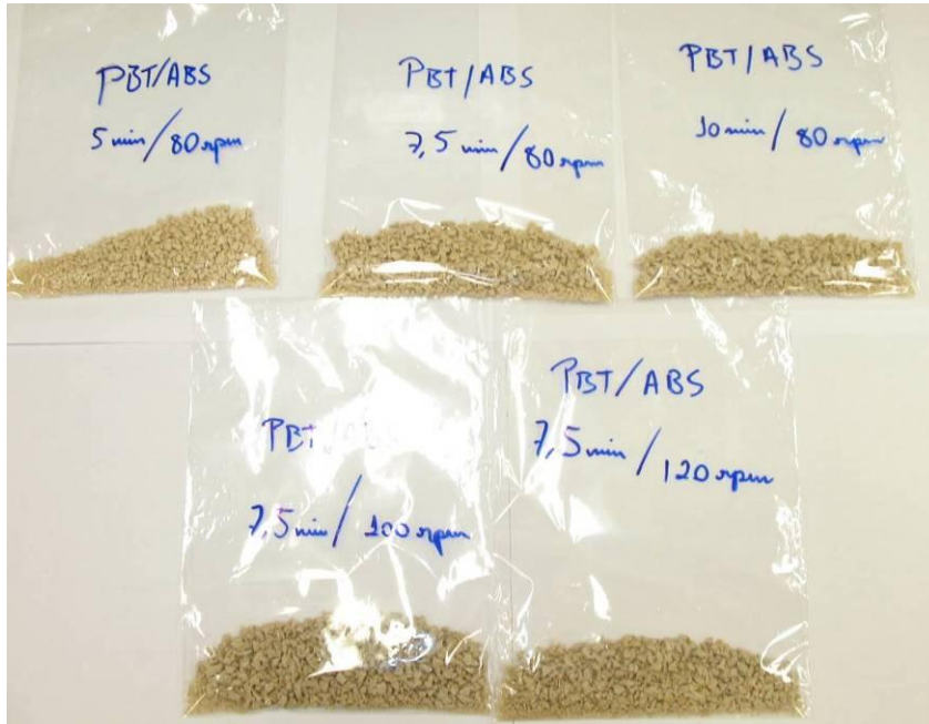
Figura 4.39 Fotografia das amostras da blenda PBT/ABS processadas em misturador interno Haake à 275^{\circ}\text{C} com diferentes tempos de processamento e velocidades de rotação dos rotores moídas em moinho de facas
