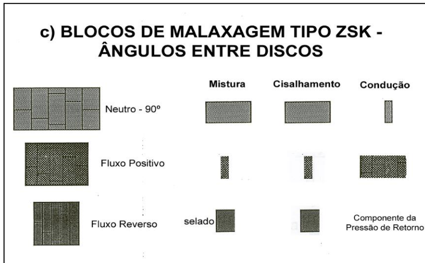
Figura 2.12 Influência do ângulo entre os discos misturadores de uma extrusora rosca dupla co-rotacional e interpenetrante, sobre as funções de mistura (distribuição), dispersão (cisalhamento) e condução [21].
