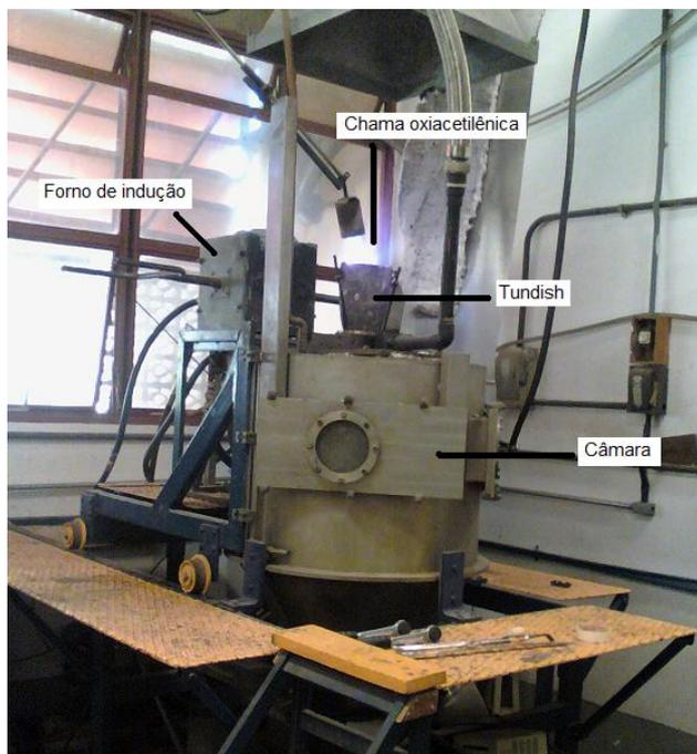
**Figura 4.2:** Imagem do equipamento de conformação por spray a ser utilizado no processo
