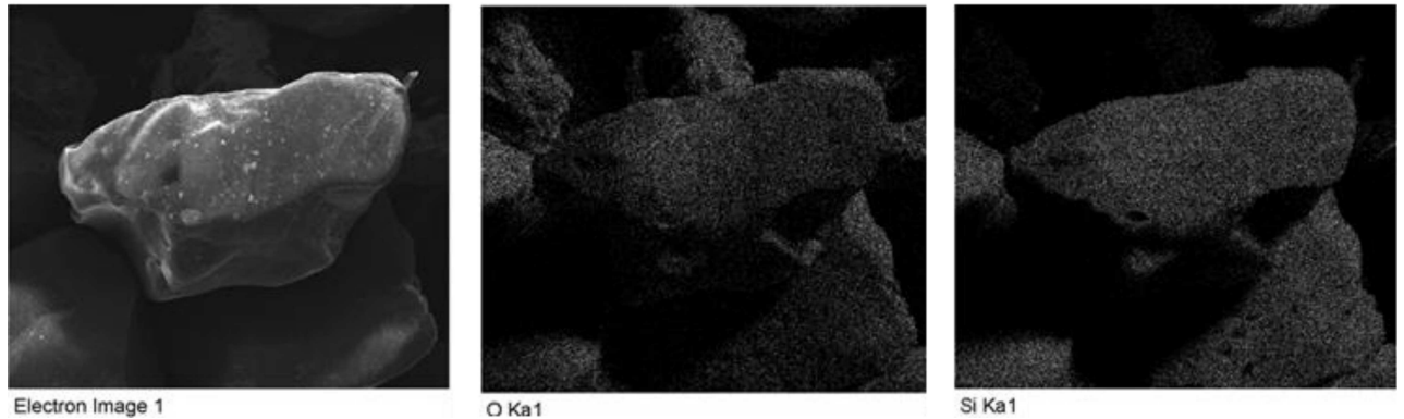
Figura 15. Micrografia das partículas de silicato encontradas nas cinzas (esquerda) e o mapeamento elemental utilizando a técnica de EDS dos espectros do oxigênio (centro) e do silício (direita).
