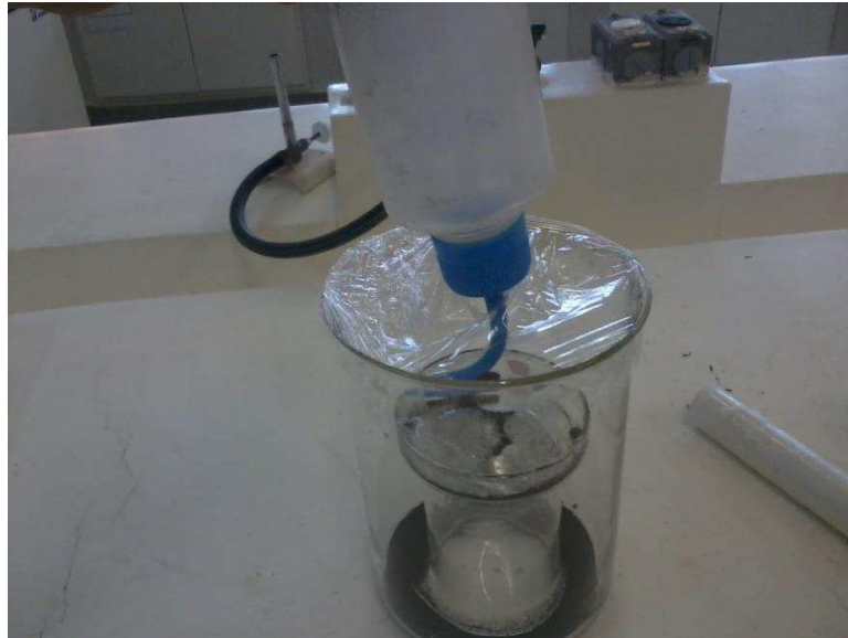
Figura 6. Foto do método de separação dos carbonosos e silicatos por diferença de densidade utilizado.
