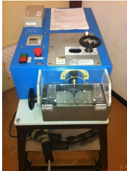
Figura 4.2: Entalhadeira para usinagem de CPs de EWF do tipo DDENT.
