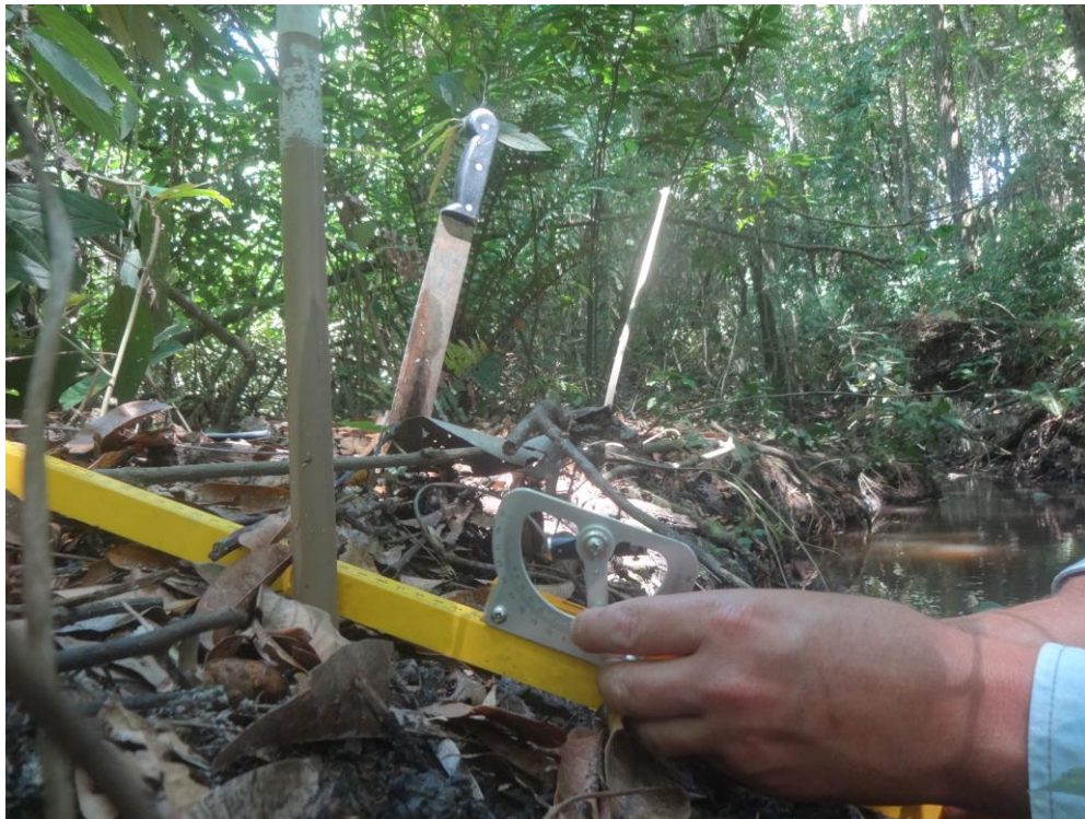
Figura 7. Exemplo de medição do ângulo da margem utilizando um clinômetro.
