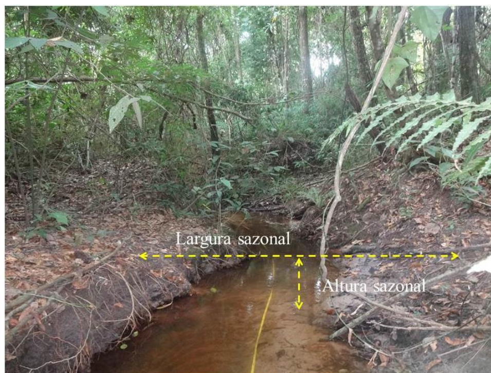
Figura 5. Exemplo da determinação da largura sazonal do leito e altura sazonal em um riacho natural.
