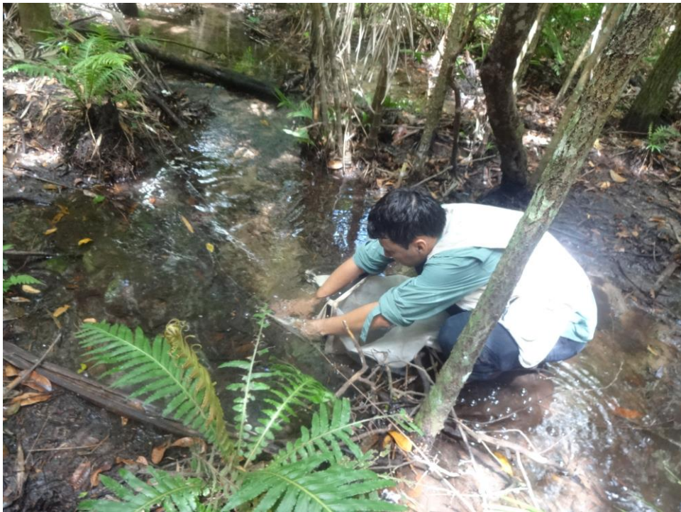
Figura 8. Exemplo de amostragem dos macroinvertebrados utilizando-se amostrador Surber.
