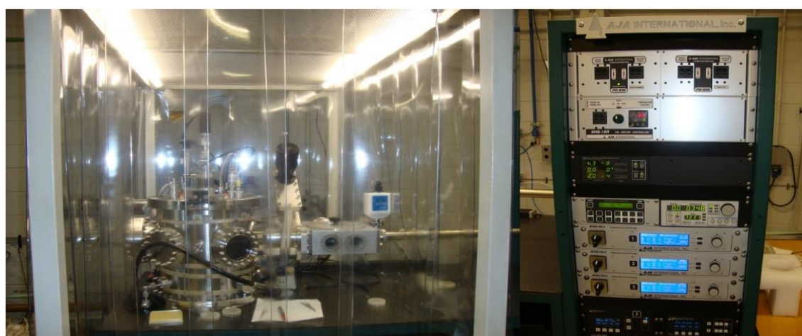
Figura 3.2 Máquina de pulverização magneto-catódica do LNNano
