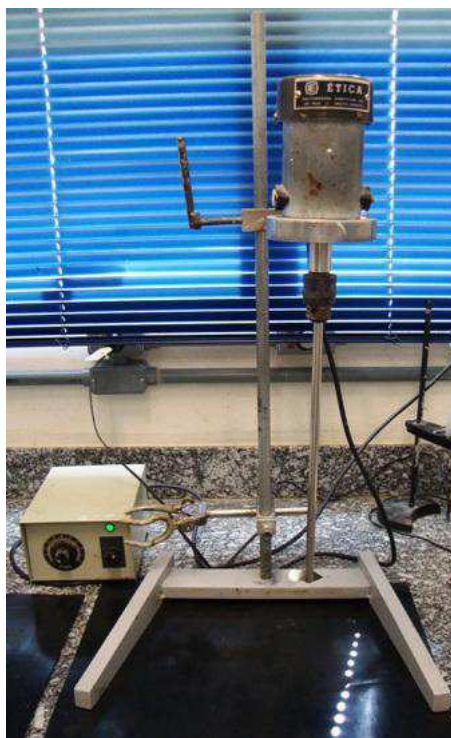
Figura 3.12. Misturador de bancada utilizado para misturar as argamassas.
