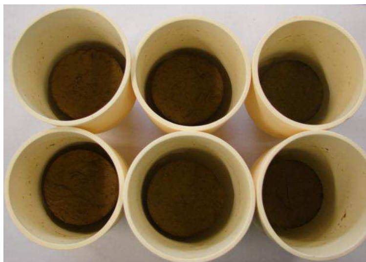
Figura 3.8. Clínquer prensado no cadinho de ZAS após a queima a 1250°C.
