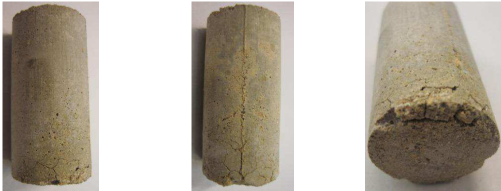
Figura 4.46. Imagens mostrando as trincas na base de corpos de resistência mecânica do F3-18a curados por 90 dias.
