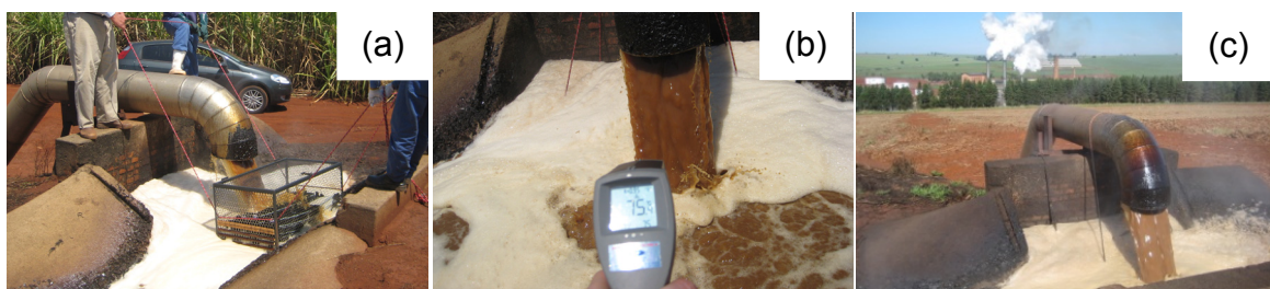
Figura 3.3 (a) Processo de imersão da caixa com amostras no tanque de vinhaça, (b) temperatura de 75°C no momento do início do processo de envelhecimento e (c) exposição no tanque de vinhaça no campo.
