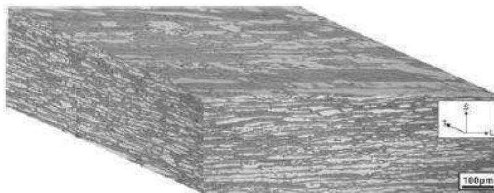
Figura 2.4 Representação tridimensional da microestrutura de um aço inoxidável super duplex UNS S32760.
