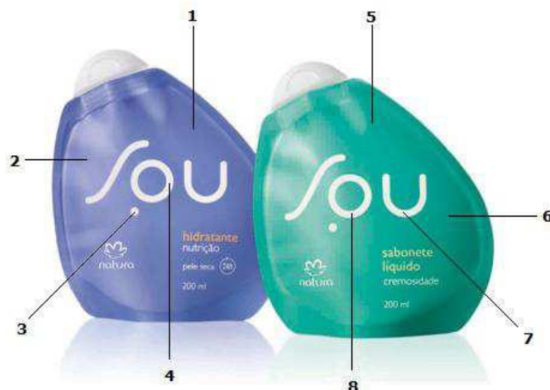
Figura C1: Representação dos filmes multicamadas laminados de PET-HDPE. Os números na figura indicam as regiões nas quais as amostras foram coletadas para a análise no DSC.
