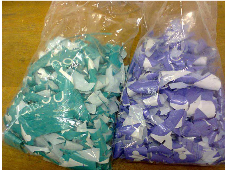
Figura 4.2: Aparas plásticas de filmes multicamadas do tipo PET-HDPE fornecidas para o estudo da reciclagem.
