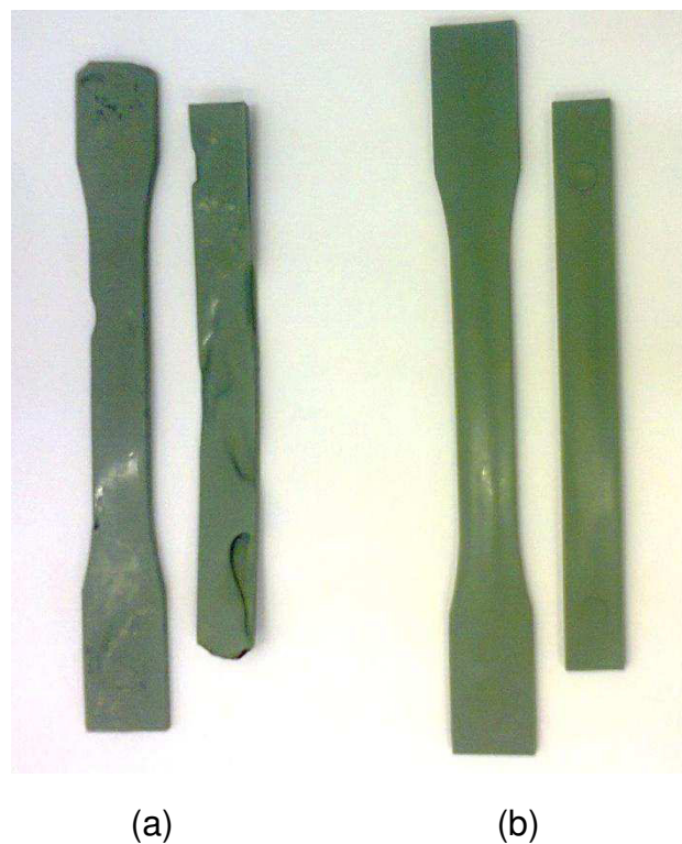
Figura 4.9: Corpos de prova injetados para as aparas compatibilizadas (a) sem diluição e (b) com diluição de HDPE virgem (50/50 wt%).
