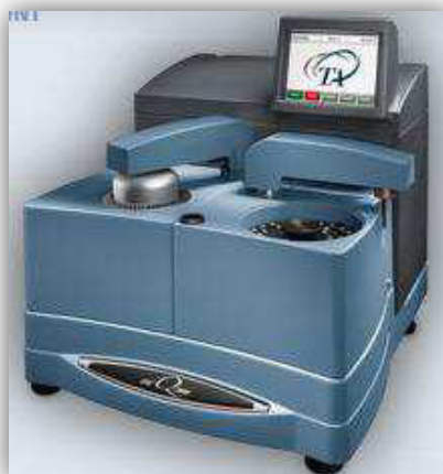
Figura 4.10: Calorímetro Diferencial de Varredura utilizado na caracterização térmica das aparas de filmes multicamadas.
