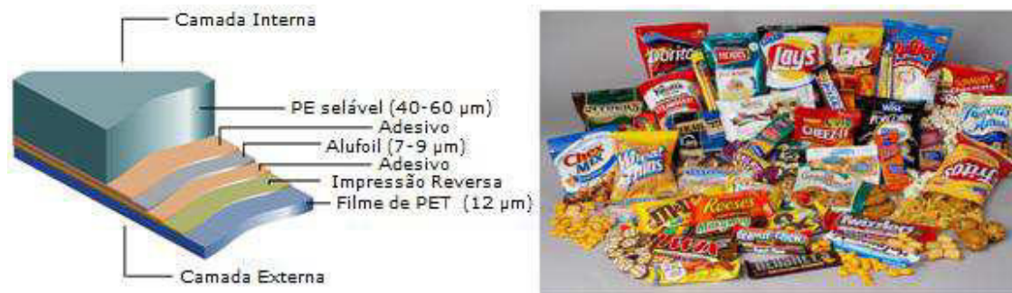
Figura 2.2: Estrutura básica de uma embalagem do tipo multicamadas.
