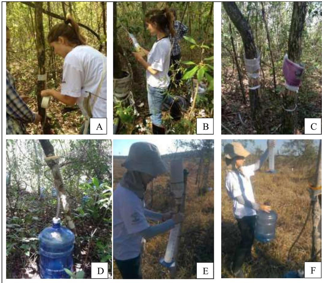
Figura 4: Etapas da instalação do escoamento pelo tronco: (A) montagem da estrutura; (B) preenchimento com espuma; (C) secagem; (D) escoamento pelo tronco finalizado. Medição do volume armazenado no pluviômetro de precipitação em aberto (E); Medição do volume armazenado no coletor (F). RPPN Floresta das Águas Perenes, Brotas, SP. 2015.
