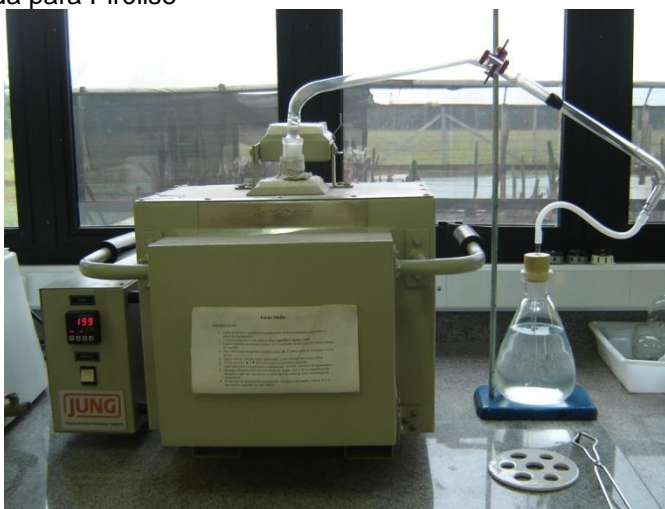
Figura 9: Mufla Utilizada para Pirólise
