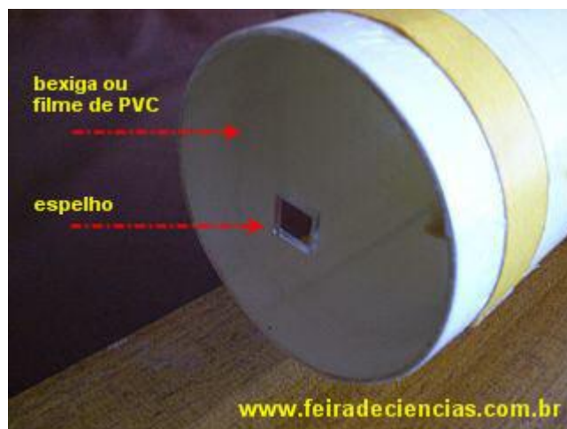
Figura 2.1: Esquema parcial do arranjo experimental
