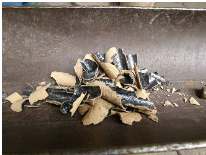
Figura 7 - Amostra retirada do forno de eletrofusão, que são enviadas para o laboratório de análise química. Cortesia da Elfusa.
