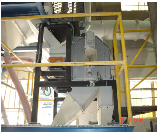
Figura 8 - Separador Magnético utilizado na separação do Fe-Si do óxido de alumínio. Cortesia da Elfusa.
