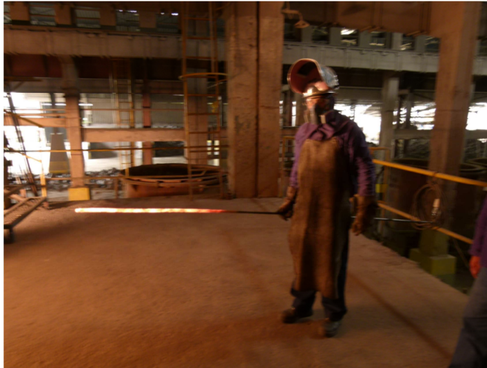
Figura 6 - Processo de retirada de amostra. Cortesia da Elfusa.
