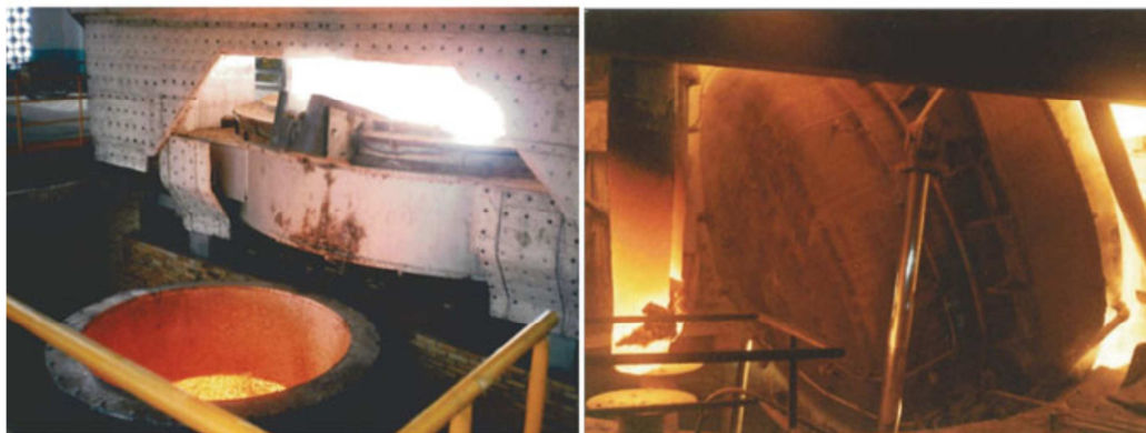
Figura 10 - Imagem ilustrativa de um forno basculante para a produção de óxido de alumínio eletrofundido.
