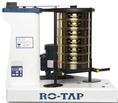
Figura 16 - Equipamento utilizado para a análise granulométrica de macro partículas-Rotap RX-29. Cortesia da Elfusa.
