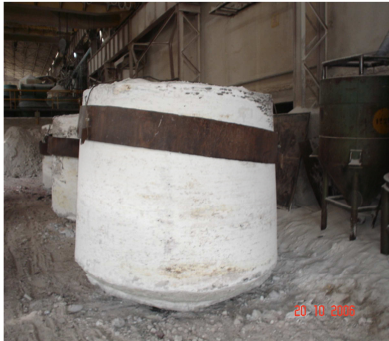
Figura 9 - Bloco de óxido de alumínio eletrofundido branco em processo de resfriamento. Cortesia da Elfusa.
