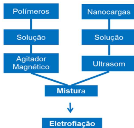
Figura 4.5 - Esquema ilustrando o processo de preparação das soluções para eletrofiação dos nanocompósitos.
