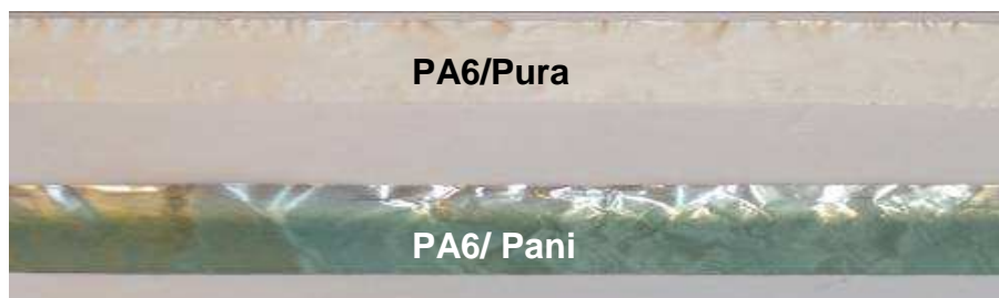
Figura 5.24 – Mantas de PA6 pura e da blenda PA6/Pani obtidas por eletrofiação.
