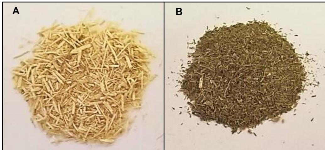
Figura 6. Biomassas de (A) bagaço de cana-de-açúcar (1mm), e de (B) raízes de alface (0,5mm), lavadas, secas e moídas.
