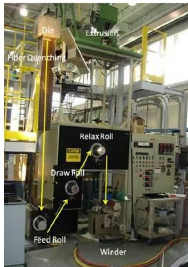
Figura 4.2 - Foto esquemática de equipamento utilizado para o processamento das fibras de polipropileno
