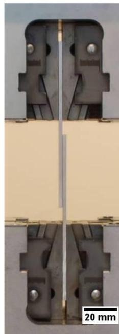
Figura 3.3 – Fixação das chapas soldadas na máquina de tração.
