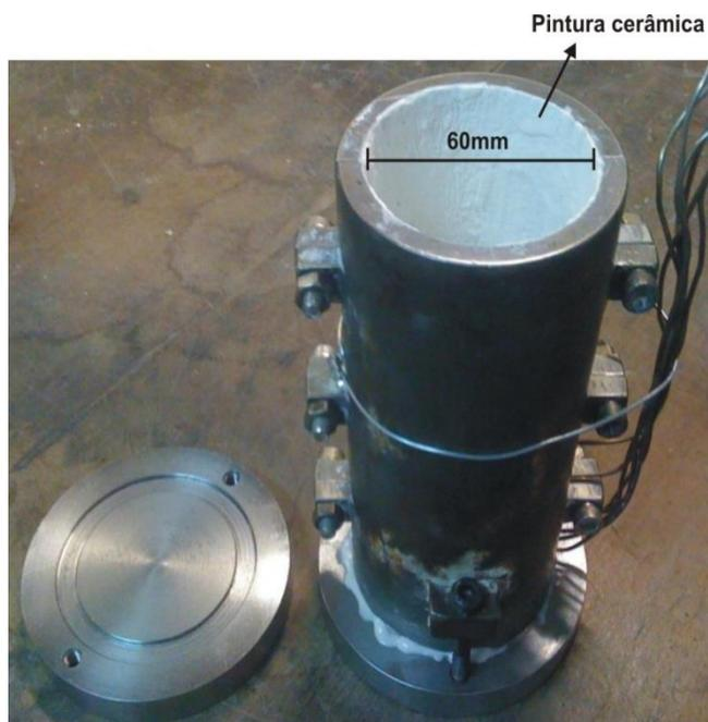
Figura 17 - Lingoteira de aço inoxidável AISI 310 com chapa molde de aço carbono 1020.
