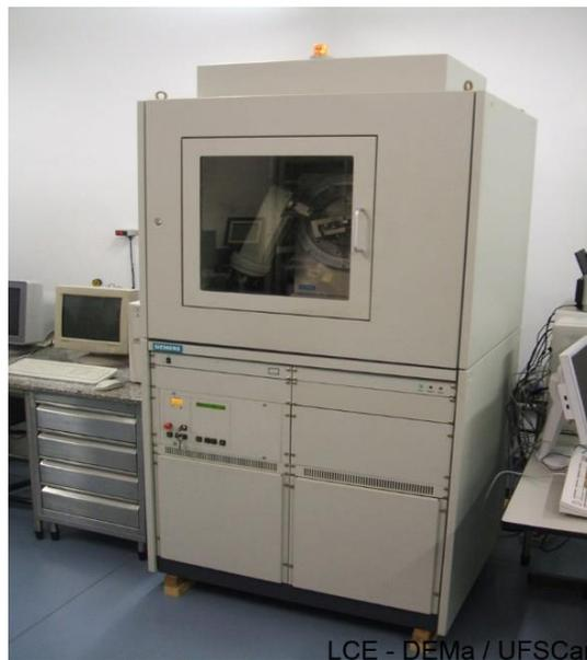
Figura 24 - Difratorômetro de Raios-X marca Siemens modelo D5000.
