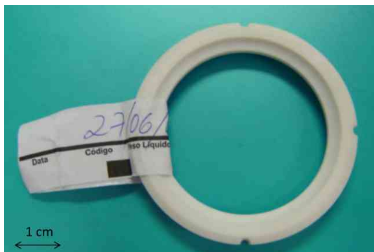
Figura 2.5: Sede de válvula moldada em PTFE 807N, cortesia da empresa DuPont do Brasil S.A.
