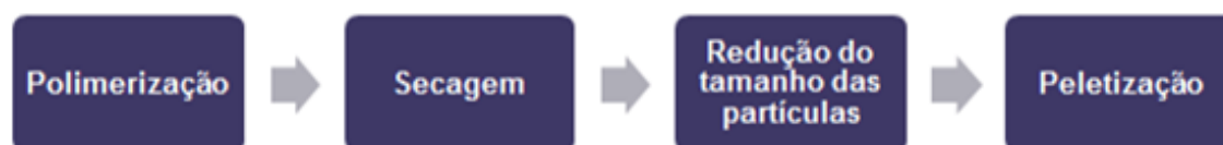
Figura 2.2: Etapas de fabricação do PTFE granular (adaptado de Ebnesajjad, 2000 [1])
