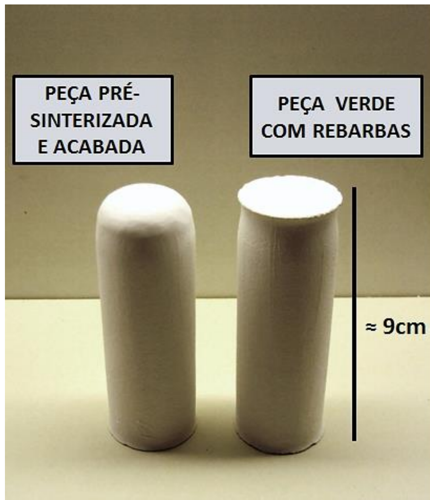
Figura 4.43- Imagem da peça pré-sinterizada e acabada e do tubo verde com rebarbas em ambas as extremidades.
