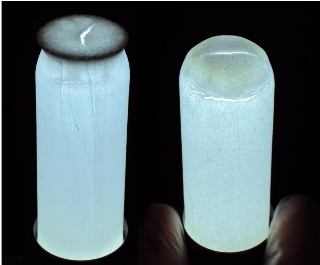
Figura 4.44- Trincas na extremidade fechada dos tubos sinterizados a 1600 °C/20min-1475 °C/2h.
