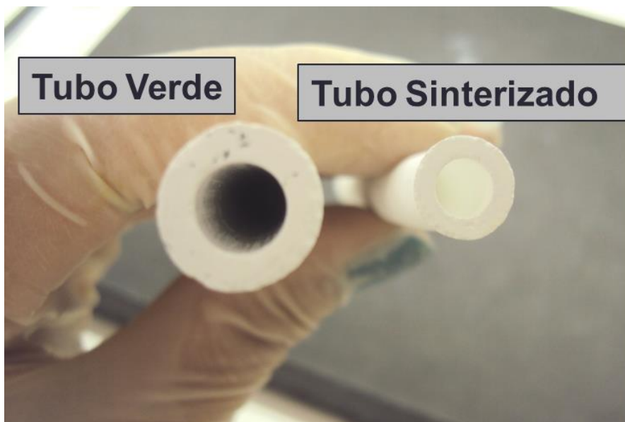
Figura 4.40- Retração e translucidez do tubo verde e tubo sinterizado.
