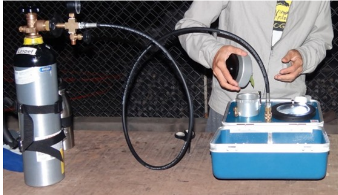
Figura 5 - Câmara de pressão usada para obter medidas de potencial hídrico das folhas.
