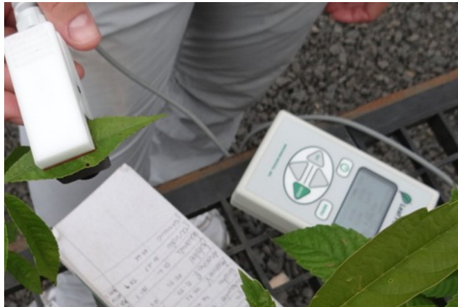
Figura 4 – Porômetro portátil usado para medidas de condutância estomática das folhas.
