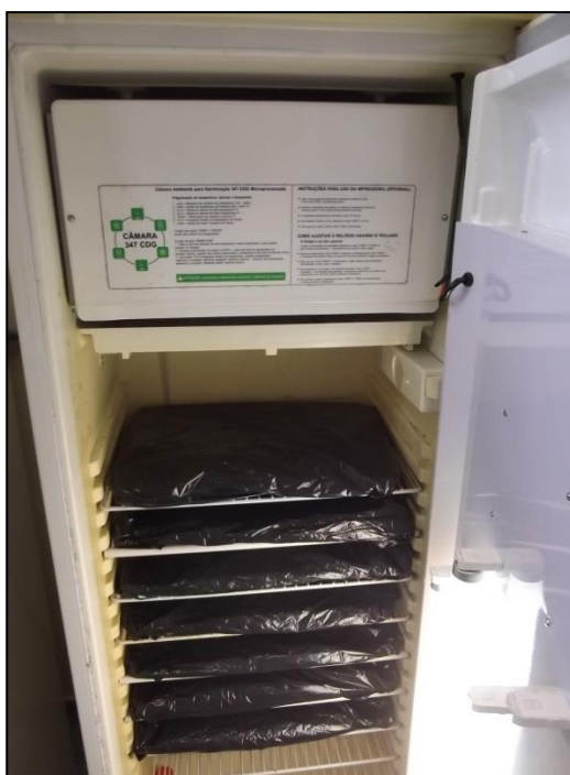
Figura 4. Experimentos de toxicidade aguda com a espécie M. flabelligera mantidos sob a mesma temperatura dos cultivos-estoque, sem alimento e iluminação.
