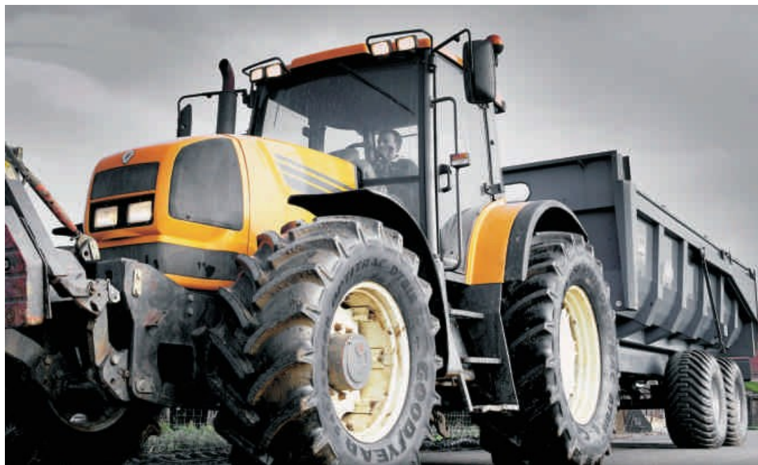
Figura 7-4 Trator pesado 370HP com TDA para arrasto de carga agrícola em vias OTR
