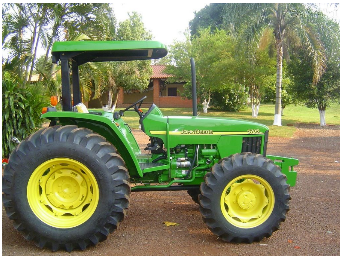
Figura 7-3 Trator pequeno porte com TDA e pneus apropriados não direcionais
