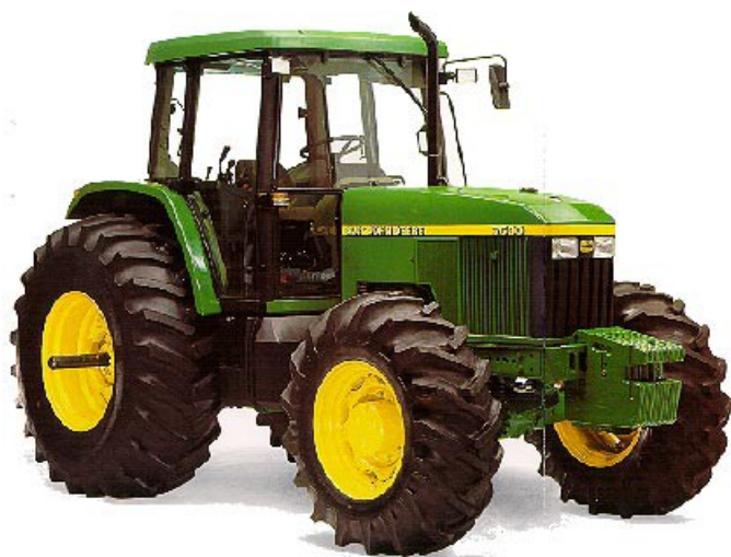
Figura 7-6 Trator representativo com pneus típicos e 323kg por pneu ponderado
