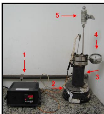
Figura 7 - Tratamento hidrotermal das nanopartículas de HAP e ZnO, sendo (1) Controlador de temperatura e tempo, (2) Agitador magnético para homogeneização da solução, (3) Forno elétrico com resistência elétrica, (4) Manômetro e (5) Válvula de segurança.
