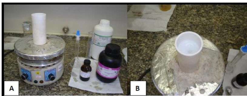
Figura 6 (A e B) - Etapas da síntese de ZnO através do método de Coprecipitação. Em A são mostrados os reagentes hidróxido de sódio e nitrato de zinco e em 6B tem-se a formação do precipitado de ZnO em agitação no recipiente de teflon.
