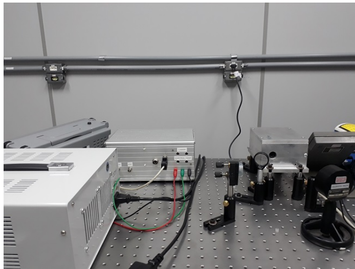
Figura 4.5: Sistema LIBS-LIF contínuo acoplado ao sistema LIBS-duplo pulso da Embrapa São Carlos.
