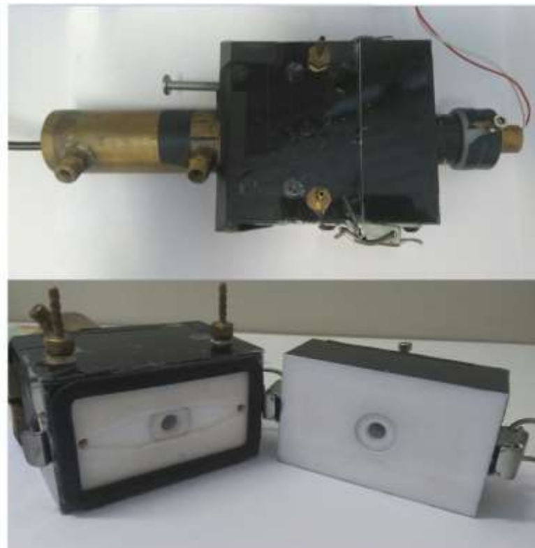
Figura 3.13 - Foto da matriz de bancada utilizada para validação do Colorímetro in-line . Acima é mostrada a disposição da fonte luminosa e fototransistor em lados opostos da matriz de teflon. Abaixo detalhe do interior do colorímetro.
