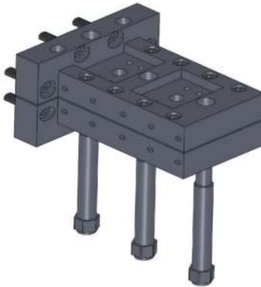
Figura 3.3 - Matriz de extrusão do tipo fenda utilizada
