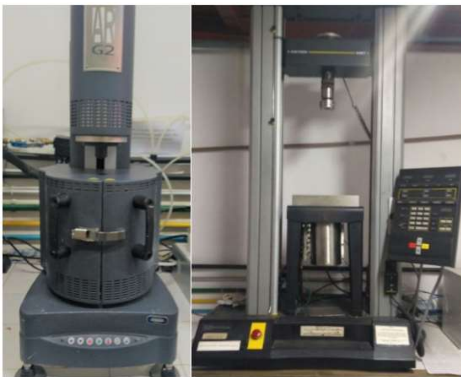
Figura 3.15 – Reômetro de placas paralelas da TA Instruments modelo ARES-G2 (Esquerda) e Reômetro capilar da Instron modelo 4467 (Direita)
