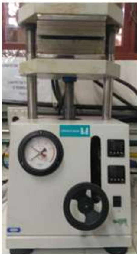
Figura 3.12 – Prensa MA098/A da Marconi utilizada no preparo dos filmes-padrão
