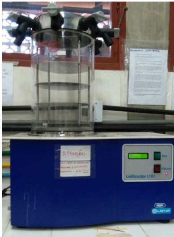
Figura 3.11 – Liofilizador L101 utilizado para a secagem das suspensões cerâmicas
